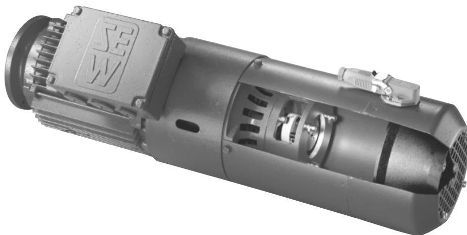
60. ábra: Háromfázisú váltakozó áramú motor EV1A jeladó-előkészítéssel és VR független hűtéssel
